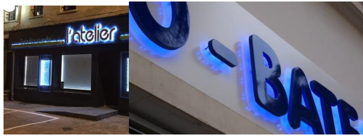
Eclairage indirect (lettres découpées lumineuses)
